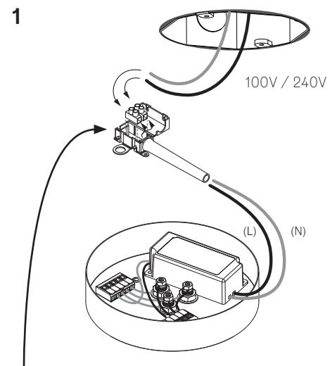
For select markets only. Wirebox (high voltage). Destinées à certains marchés uniquement. Boîtier électrique (haute tension). Nur für bestimmte Märkte. Kabelkasten (Hochspannung). Para mercados selectos. Caja de cables (alta tensión). Solo nei mercati selezionati. Giunzione elettrica (alta tensione). 一部の市場のみを対象としています。接続ボックス (高電圧)。 предназначена только для отдельных рынков. Коробка проводки (высокого напряжения). قم بتوصيل الأسلاك الحية (L)، محابد إلى محابد (N). لأسواق محددة فقط.
