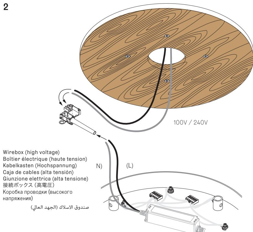
Remote power supply Alimentation à distance Fernspeisung
